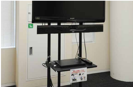
▲ カメラ一体型のCS-700AVはモニター下に設置
