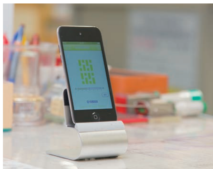
YVSP Tool：緑と赤の点灯で適切な声量を表示します
