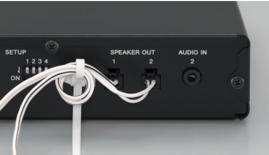
付属品のスピーカーケーブル(5m)でスピーカーとアンプリファイアーを接続
